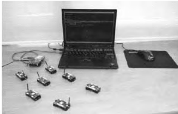
Fig. 10.9 MicaZ mote test-platform
