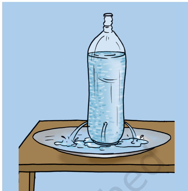
चित्र 11.16 : द्रव बर्तन की दीवारों पर समान गहराई पर समान दाब डालते हैं।
